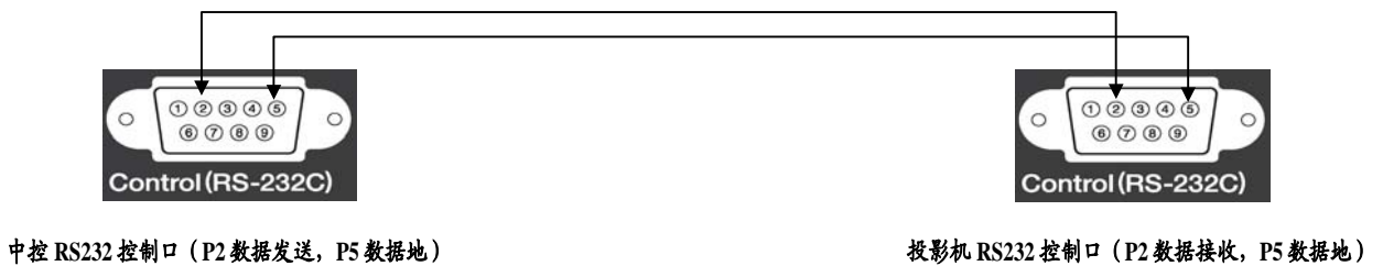
EPSON投影机RS232 控制连接图
