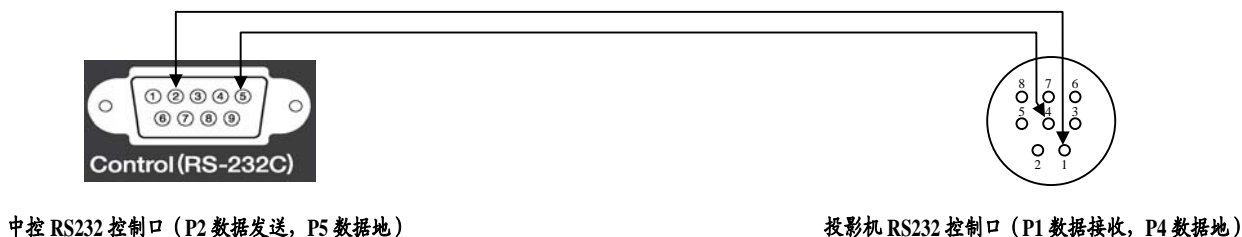
东芝投影机RS232 控制连接图
